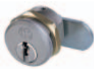
Hebelzylinder Nr. 5558/30 PSM Messing poliert vernickelt Schließbewegung 90° Schließweg nach Wahl Einbaumaß 25 mm
